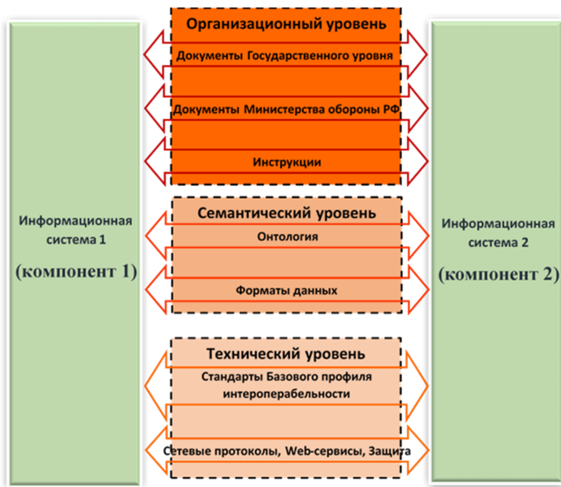
Рисунок 14 — Модель интероперабельности для информационных систем военного назначения
